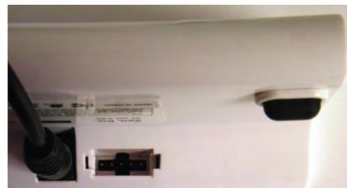
Abbildung 53: serielle Anschlusschnittstelle des Zeo-Stationsgerätes
