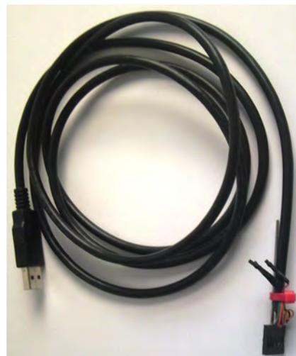
**Abbildung 54:** Modifiziertes 5 V FTDI-Kabel
