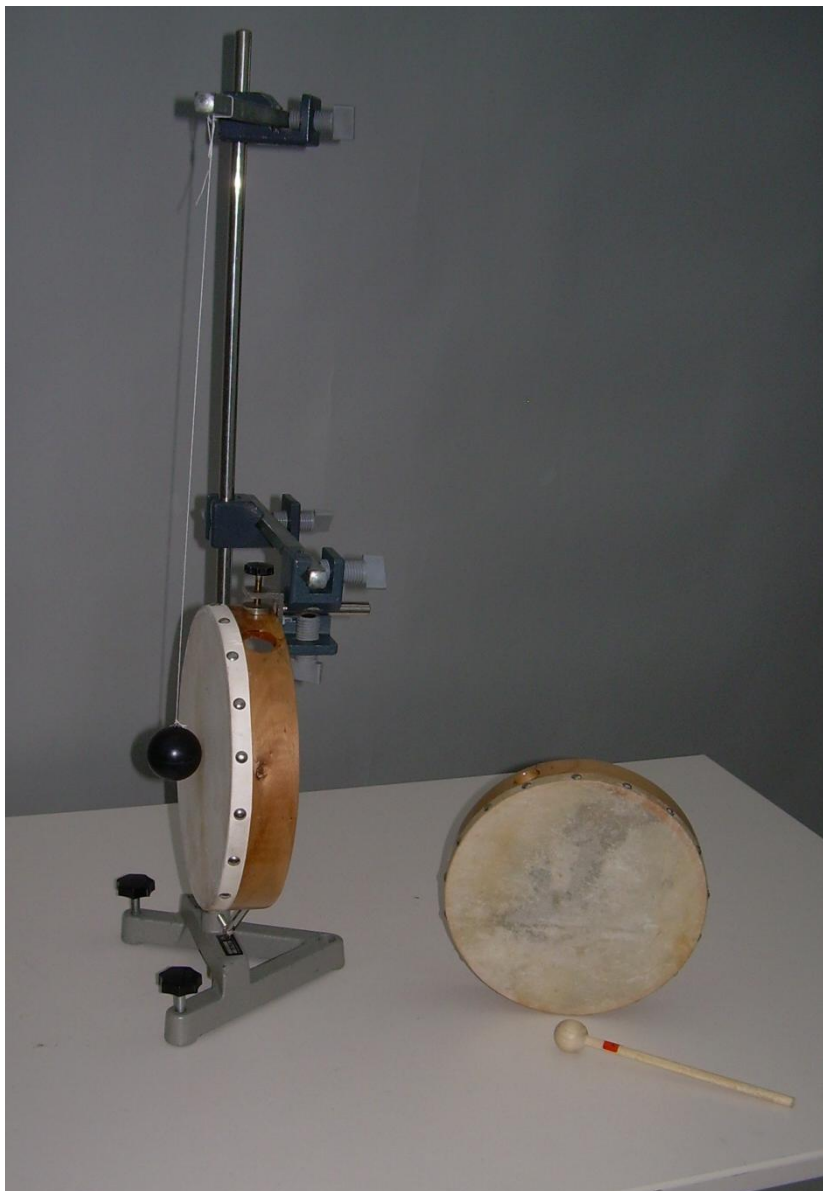
Abbildung 112: Aufbau des Versuchs "Resonanz am Tamburin"
