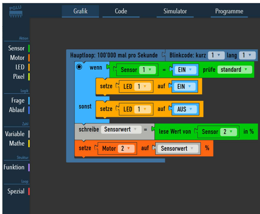
Abbildung 10: Beispielsketch in der visuellen Programmieroberfläche von PGLU. Am linken Bildrand können vorgefertigte Bausteine aus den dargestellten Kategorien ausgewählt werden. Diese Bausteine können im Hauptfeld zu einem Sketch zusammengepuzzelt werden. In der oberen Funktionsleiste kann man zwischen visuellem und klassischem Programmieren sowie der Simulation wechseln.
