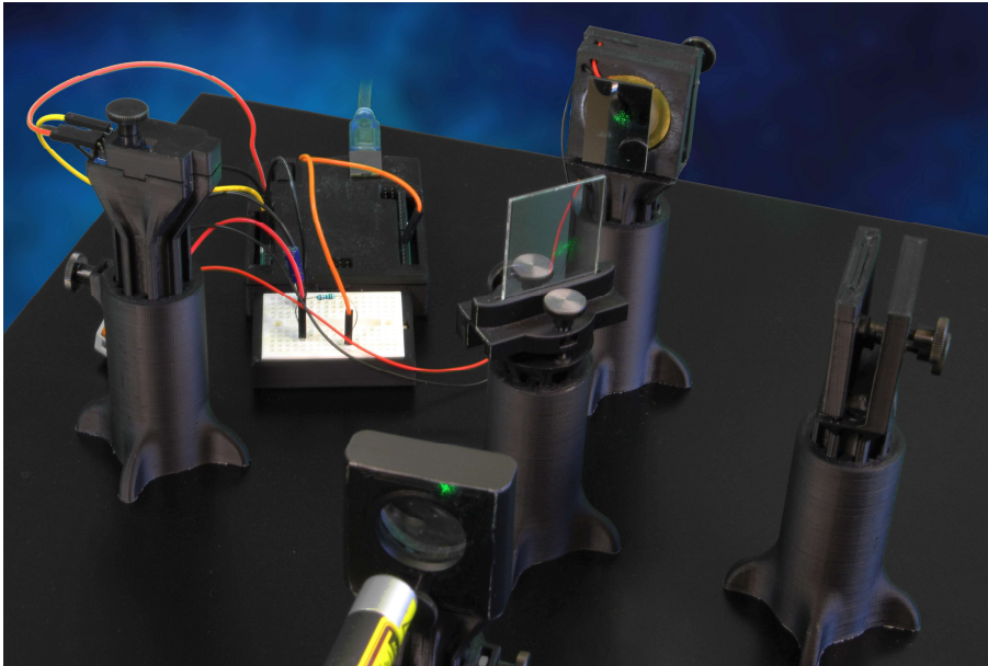
Abbildung 15: Aufbau eines Analogieexperiments zur Gravitationswellendetektion des S'Cool Labs Am CERN
